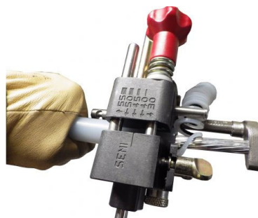
絶縁体剥ぎ取り
